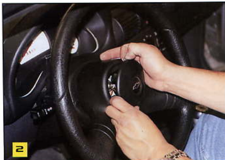
Para empezar, retiramos la tapa del volante original como se muestra en la gráfica.
