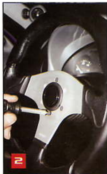
2 Con la ayuda de una punta Allen de 5/64 retiramos la tapa del volante Momo Millennium. Después con la punta de 1/8 quitamos el volante, como se muestra en la gráfica.
