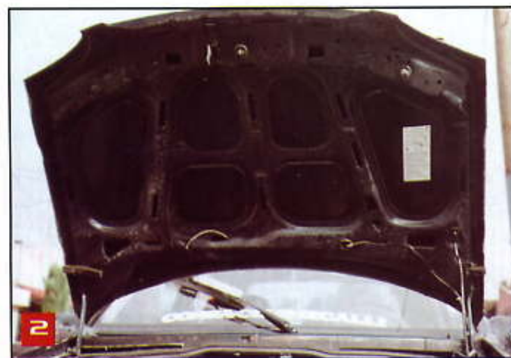
2 Así se aprecia la cara interior del cofre, antes de colocar la lámina-espejo.
