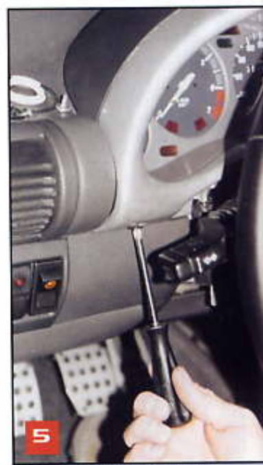
Con el mismo desarmador de cruz, retiramos los dos tornillos que sujetan el marco del tablero.
