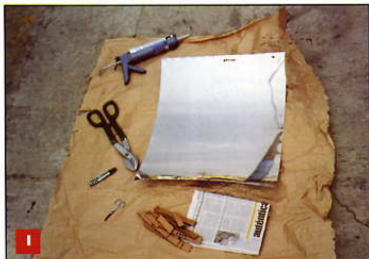
1 Éste es el material que necesitaremos: un trozo de lámina de acero inoxidable de 1 m x 90 cm, calibre 20. Tijeras para cortar lámina y papel, marcador, silicón con todo y pistola aplicadora, hojas de papel periódico, tiras de cartón corrugado (1 cm x 10 cm aproximadamente).
