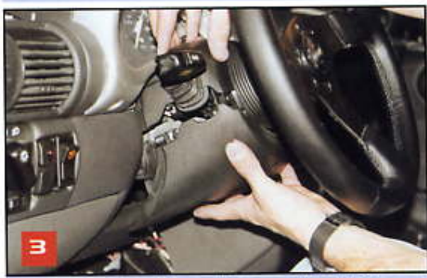
Una vez que retiramos dichos tornillos quitamos la funda inferior, como se muestra en la gráfica
