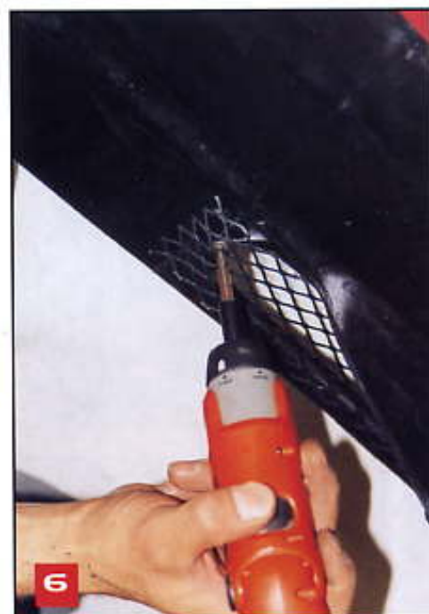
6 El color original de la rejilla es negro, pero lo podemos cambiar a conveniencia. En este caso decidimos aplicarle un tono en cromo con pintura en aerosol, a fin de darle un toque deportivo y hacerlo combinar con la carrocería. Para esta labor, retiramos la rejilla del faldón con la ayuda de un desarmador de cruz.
