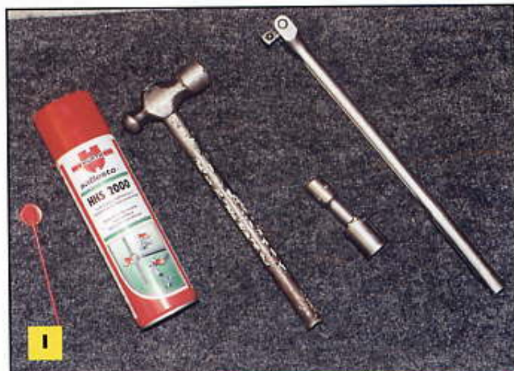
Las herramientas que se utilizarán son las siguientes: Un maneral, dado de 22 mm, martillo y lubricante en aerosol. El volante que decidimos instalar es un Momo.
