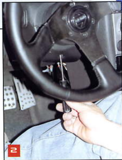
Con un desarmador de cruz retiramos los dos tornillos que sujetan las cubiertas del switch.
