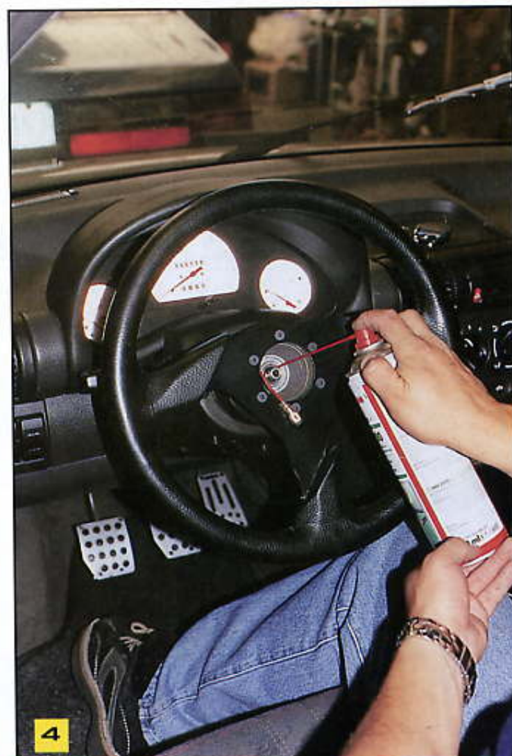
Para aflojar la tuerca de la flecha de dirección con mayor facilidad, rociamos un poco de lubricante en aerosol.
