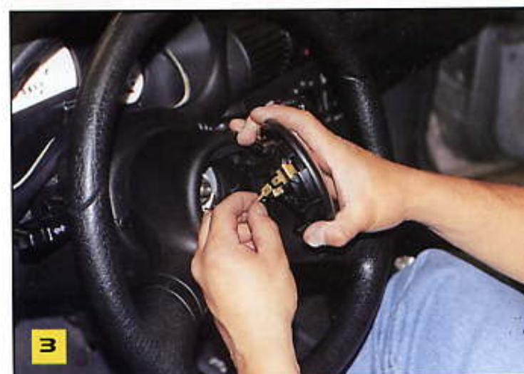
Quitamos los cables de corriente del claxon.
