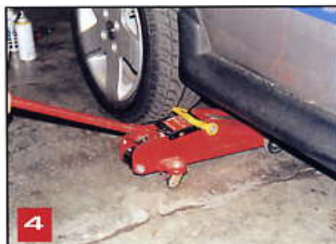
4 Levanta la parte trasera del coche con la ayuda de un gato y asegúralo con un par de torres.
