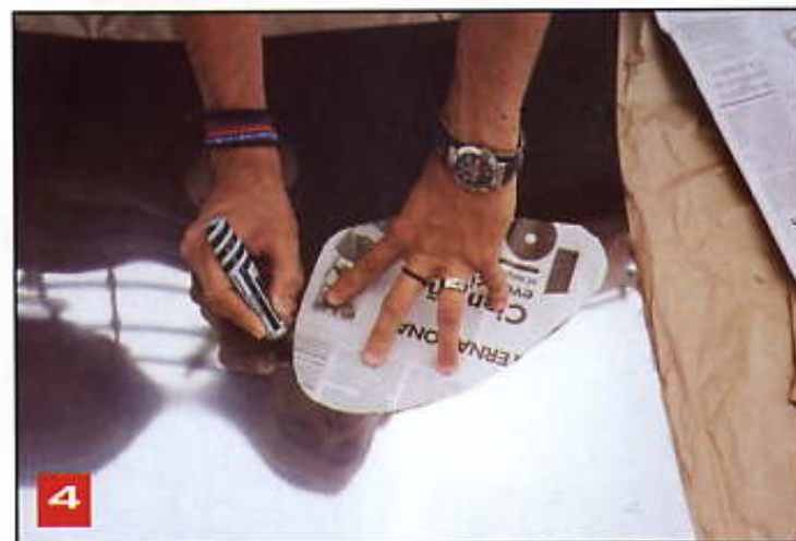
4 Una vez que has obtenido todos los moldes y los hayas presentado en el cofre para verificar que coincidan perfectamente, cópialos en la lámina-espejo con el mismo marcador.
